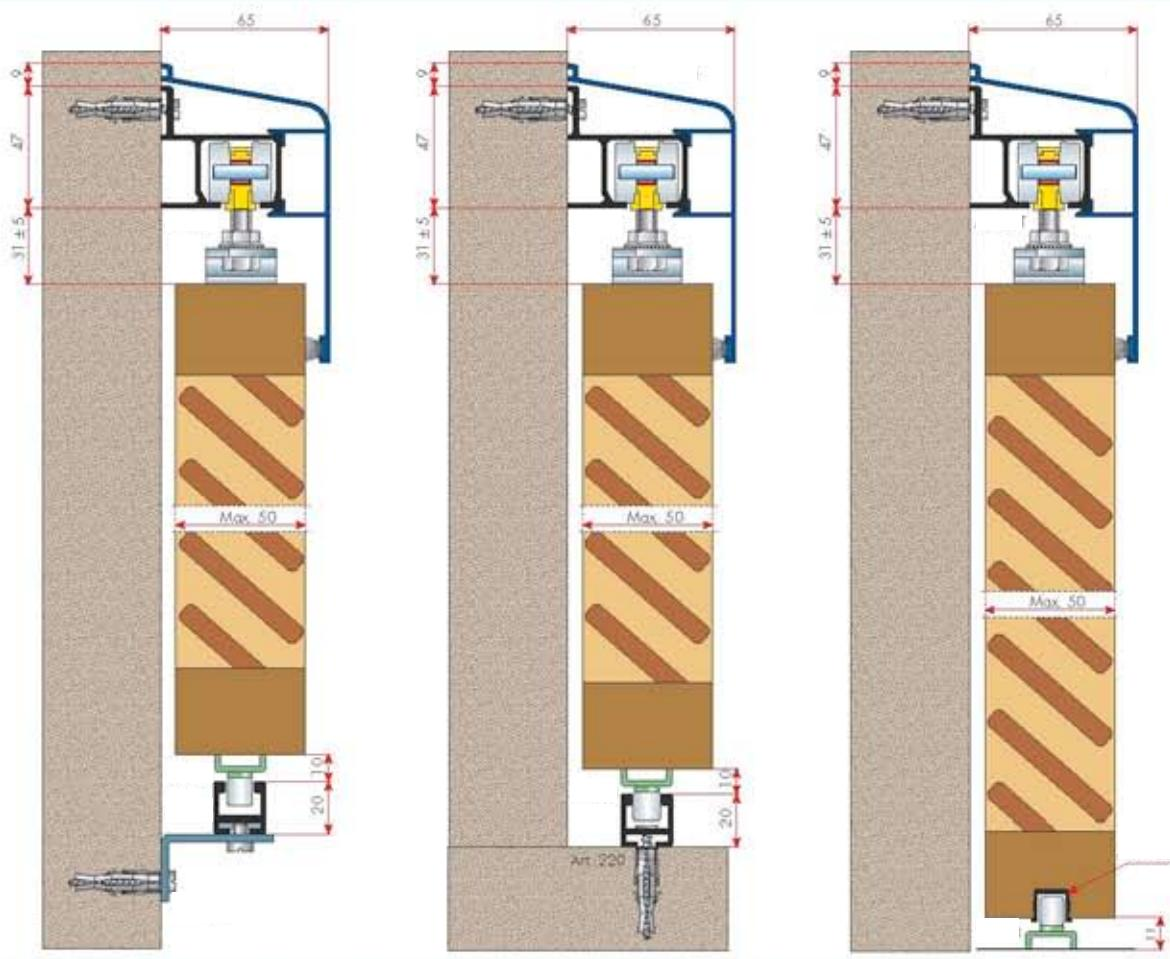
Accessori per gelosia scorrevole, con portata massima di Kg. 80 e con larghezza massima di mm. 50
