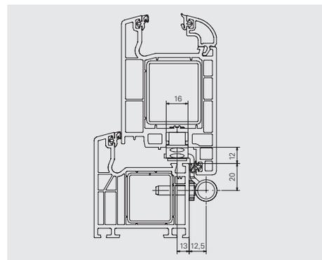
**Applicazione:** Estetic 3DN–Cerniera per cava 16mm posizione 13 mm su PVC
