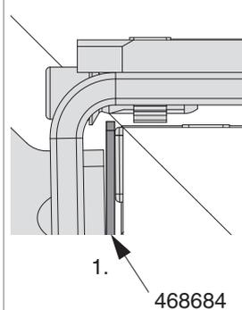
1. Nella regolazione laterale delle forbici fino alla Gr.2 è obbligatorio utilizzare lo spessimetro cod. 468684, per evitare di scendere sotto la quota minima di regolazione!
