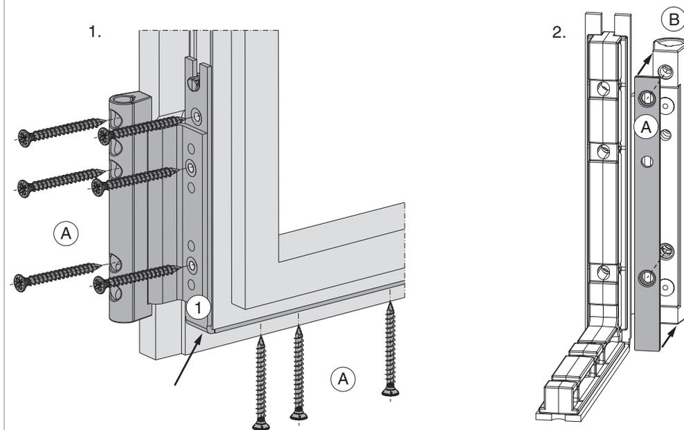
1. Inserire l'angolo cerniera nella cava ferramenta e avvitare con nove viti (A) minimo  $\varnothing 4 \times 25$  mm. 2. Opzionale: Gli spessori (A) (Art. Nr. 363306 = 2 mm, Art. Nr. 363307 = 3 mm) sono utilizzati in combinazione con l'angolo cerniera (B) per adattarlo alle diverse altezze battute.
