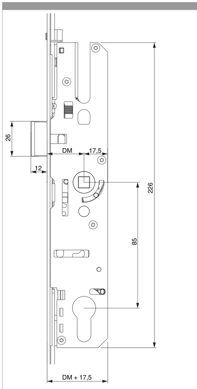
Larghezza fresata per scatola serratura portafinestra min. 15,5 mm
