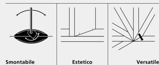
Clamex P-14 è una giunzione smontabile che si può fissare in pochi secondi a filo della scanalatura per P-System nel pezzo da lavorare. Grazie al piccolo foro d'accesso da 6 mm, Clamex P-14 si blocca e si sblocca con forza tramite un gancio.
