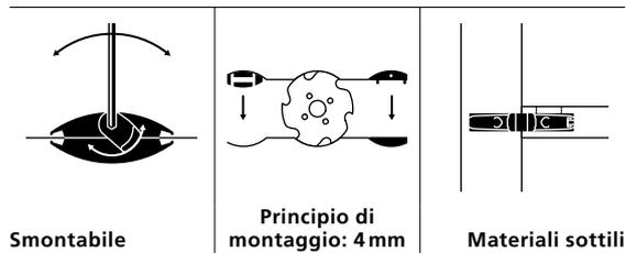
Clamex S-20 è una giunzione smontabile per il sistema Lamello, adatta su materiali con spessori a partire da 16 mm e che viene fissata nella scanalatura con apposite viti.
