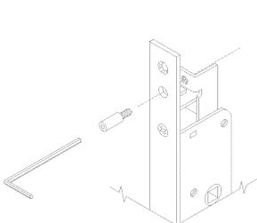
Serratura da infilare per montanti, CHIUSURA TRIPLICE, cilindro a profilo europeo.
