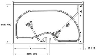
Misura X = 411 (per modulo 900 mm) Misura X = 561 (per modulo 1200 mm)
