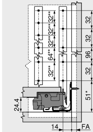
Misure di foratura – frontale – montaggio EXPANDO
