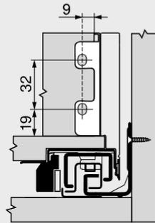
**Misure di foratura – frontale – alloggiamento meccanismo di trascinamento**
