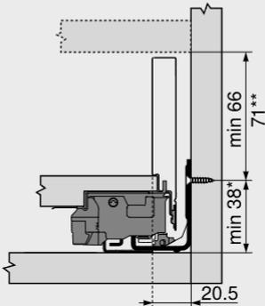
\* +1 mm in caso di montaggio della guida fianco prima di assemblare il corpo mobile
