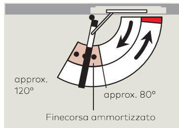
Il braccio a slitta G 96 N20 include: la canalina, la leva di collegamento, il blocco di scorrimento, il finecorsa ammortizzato e le viti di fissaggio, e può essere abbinato ad entrambi i formati di chiudiporta della gamma ITS 96. Il braccio a slitta G 96 N20 è regolabile in versione K8 e K12.
