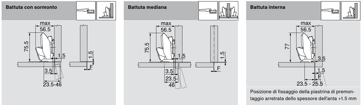
Posizione di fissaggio della piastrina di premontaggio arretrata dello spessore dell'anta +1.5 mm
