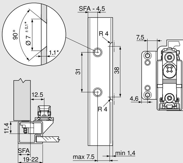
Con una larghezza del telaio pari a 19 mm è ammessa una SFA di 11-18 mm.
