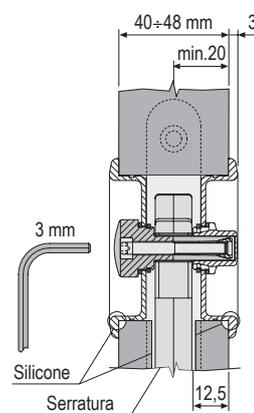
**ANELLO COMPENSATORE Ø48 mm PER CAMPI DI APPLICAZIONE 36-40 mm**
