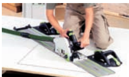
Fissato in modo sicuro e pulito: montare l'adattatore al binario di guida, applicare GECKO, stringere e fissare.
