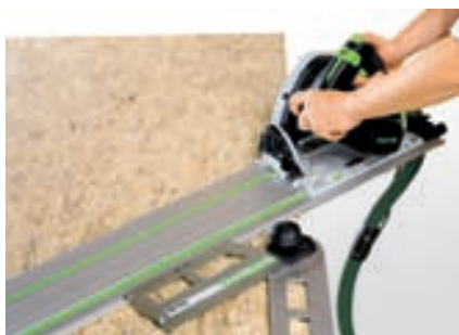
Trasferire gli angoli sul pezzo in lavorazione è facile, con la falsa squadra e il binario di guida.
