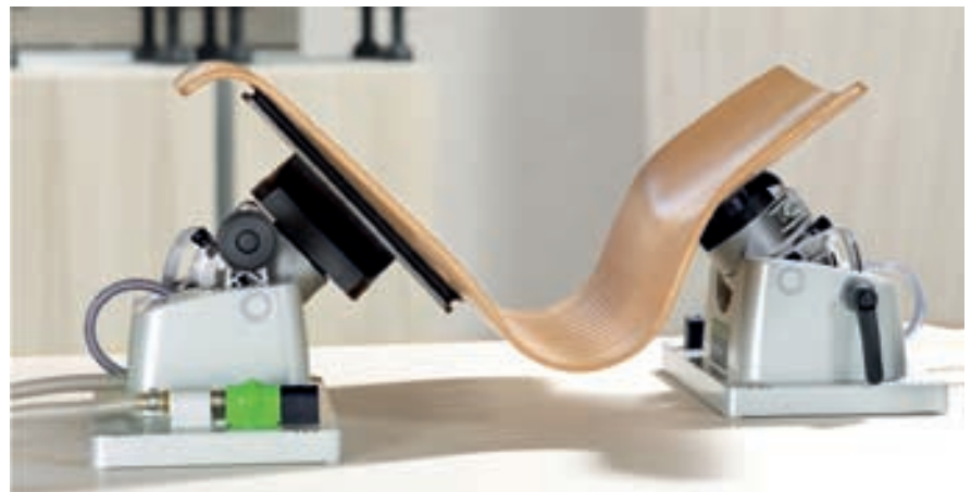
Per il sistema di bloccaggio a vuoto VAC SYS bloccare i pezzi arcuati non è un problema.
