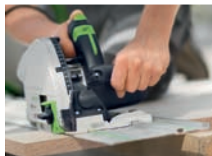
Per un taglio senza strappi e per lavorazioni più rapide con la sega: binario di guida più sega ad affondamento.
