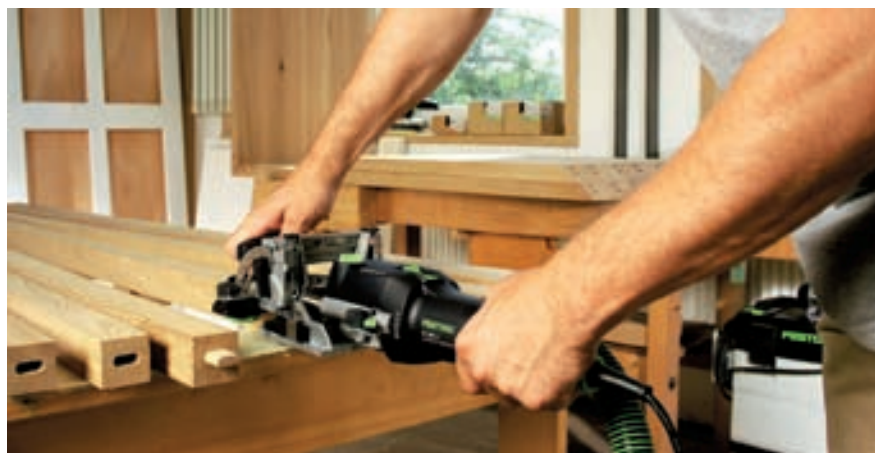
Gli accessori intelligenti facilitano il lavoro: con la battuta per listelli si possono allineare senza problemi listelli di legno stretti anche per la fresatura a taglio obliquo.
