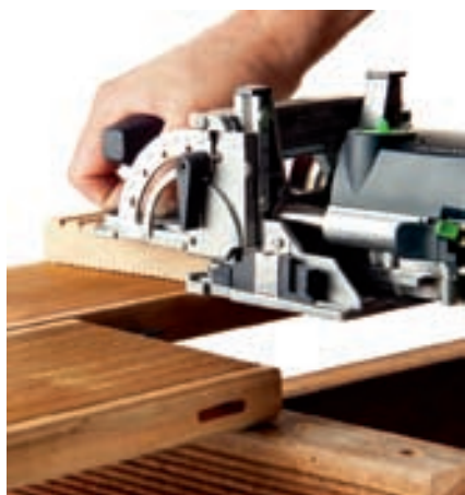
Giunzioni in legno senza viti a vista
