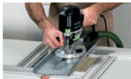
Con la slitta di fresatura MFS-FS si possono realizzare in modo semplice e pulito fresature di grandi dimensioni:
