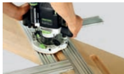
Anche i gradini delle scale possono essere fresati con la MFS con precisione nei fianchi.
