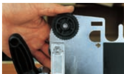
Per un posizionamento sicuro e ripetibile di pezzi in lavorazione e dima c'è il disco eccentrico Memory e il semplice sistema di bloccaggio.
