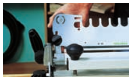
Per fresare parecchi pezzi uno dopo l'altro si può semplicemente ripiegare in alto la dima. Non è necessario smontarla.
