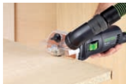
Fresatura a filo di listelli in plastica o in legno massiccio.
