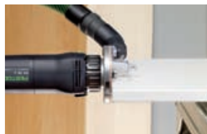
Arrotondare listelli incollati in plastica o legno massiccio.
