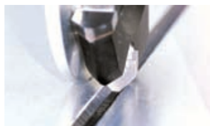
Con l'ausilio del rullo tastatore, la precisione della profondità di fresatura è garantita. La fresa affonda nel materiale per la profondità che il rullo tastatore consente.
