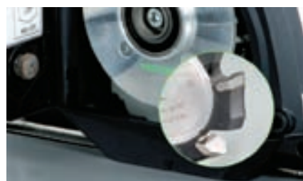
La fresa a disco e il rullo tastatore sono sostituibili. In questo modo PF 1200 può essere adattata in qualsiasi momento ai diversi spessori del materiale.
