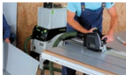
Aspirazione perfetta dei trucioli con un tubo flessibile d'aspirazione da 36 mm e un'unità mobile d'aspirazione Festool.
