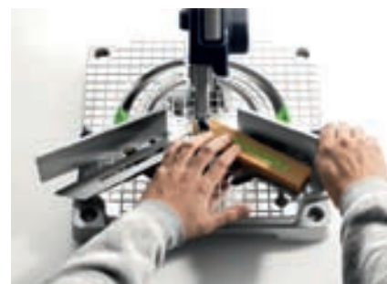
Con falsa squadra e riscontro brevettato: con SYMMETRIC per tagliare i listelli in modo semplice ed esatto.
