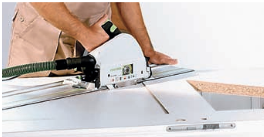
Pratico per ogni intaglio: con una sega ad affondamento Festool e il binario di guida il taglio è sicuro ed esatto – anche in caso di forme geometriche complicate.
