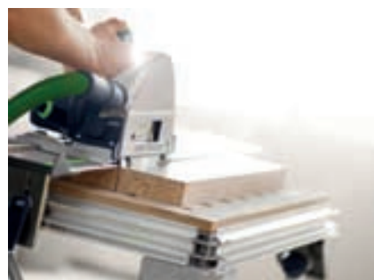
Bloccaggio sicuro e guida migliore: le seghe ad affondamento in combinazione con l'MFT.
