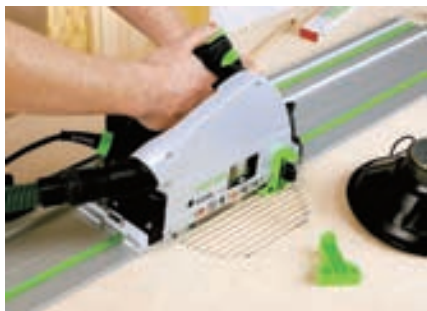
Taglio senza strappi sui due lati, grazie al binario di guida e al paraschedge applicabile.
