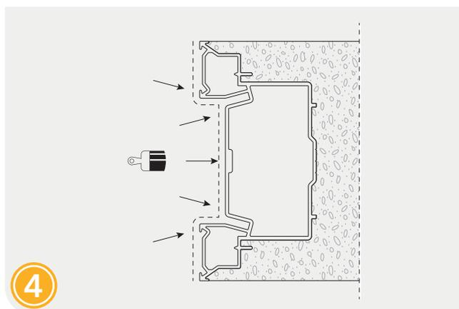
Togliere il profilo di protezione in PVC e pitturare il montante di battuta.
