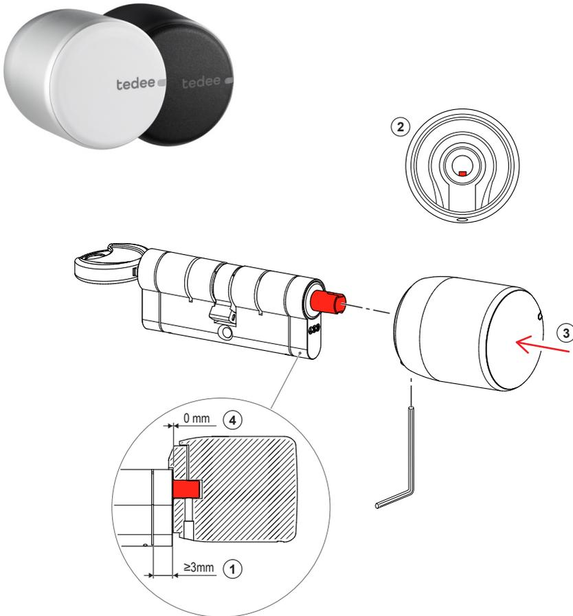
1. Assicurarsi che sul lato dell'installazione il cilindro sporga di almeno 3 mm
