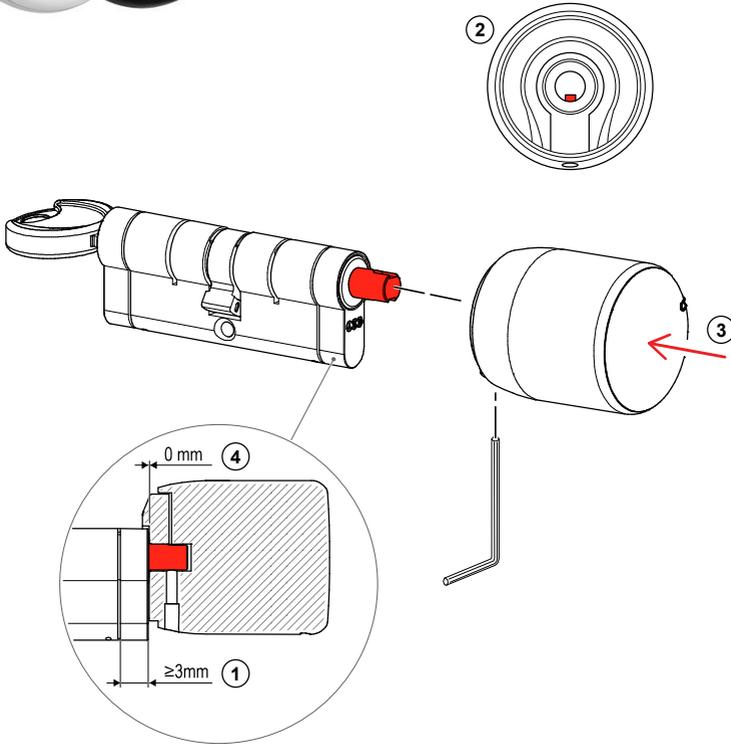
1. Assicurarsi che sul lato dell'installazione il cilindro sporga di almeno 3 mm
