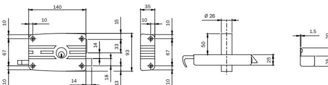
Serratura da applicare ZINCATA senza aletta per ferro, **DESTRA**. 4 fori di fissaggio. Cilindro interno e cilindro fisso  $\varnothing$  mm 26x50 esterno, scrocco reversibile separato con TIRANTE INTERNO e richiamo con chiave esterno. CATENACCIO a 3 mandate. 3 CHIAVI. Bocchetta. (Chiave grezza codice 020259)
