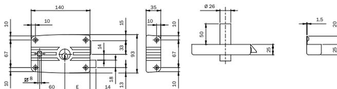
Serratura da applicare per ferro senza aletta, ZINCATA, con cilindro interno e cilindro fisso  $\varnothing$  mm 26x50 esterno, scrocco separato, QUADRO MANIGLIA mm 8. CATENACCIO a 3 mandate. Entrata mm 60. 3 CHIAVI. Bocchetta. Ghiera. (Chiave grezza codice 020259)
