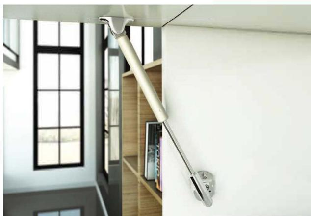
Disponibile in quattro diverse lunghezze: L. 164 mm, L. 244 mm, L. 355 mm e L. 480 mm. Disponibile in due versioni: soft stop, l'anta viene spinta in modo graduale e continuo fino alla sua massima apertura; frizionata, l'anta può essere fermata in fase di apertura e di chiusura nella posizione desiderata. Unica per la possibilità di regolazione della forza di chiusura e dell'allineamento delle ante adiacenti. Particolari realizzati in zama nichelata, acciaio e materiale tecnoplastico.
