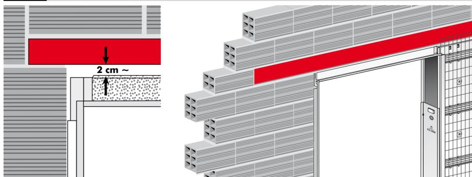
E' necessario inserire un architrave. Lasciare una luce di circa 1 o 2 cm. tra l'architrave e la traversa superiore del contro telaio.
