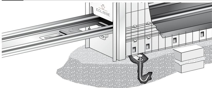
**A pavimento grezzo:** Prima della posa in opera del contro telaio estrarre le alette del sottoporta, e successivamente, durante la posa, inserire dei chiodi (non forniti) nei fori delle alette e annegarli nel getto (vedi disegno a lato).
