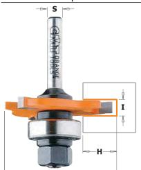
Lavorazione di gradini o scanalature, realizzazione di scanalature per listelli o biscotti in legno, fresatura di incastri a maschio e femmina oppure a T. Ogni fresa ha tre taglienti in micrograna di carburo ed è ricoperta di resina PTFE di colore arancio con design anticontraccolpo. Le frese a disco e i relativi alberi portafrese sono disponibili anche singolarmente. Altri cuscinetti sono disponibili nella sezione ricambi.
